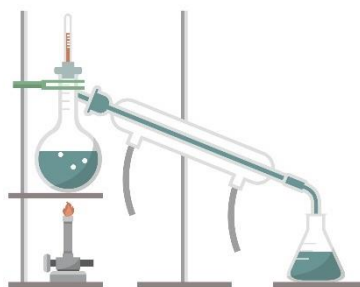
Figura 2 – Processo simples de destilação para a retirada do álcool das polpas fermentadas.
